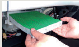
フィルター交換
